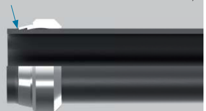
Materialaufwurf ca. 80 % (bei Edelstahlrohren: sichtbarer Materialaufwurf)
