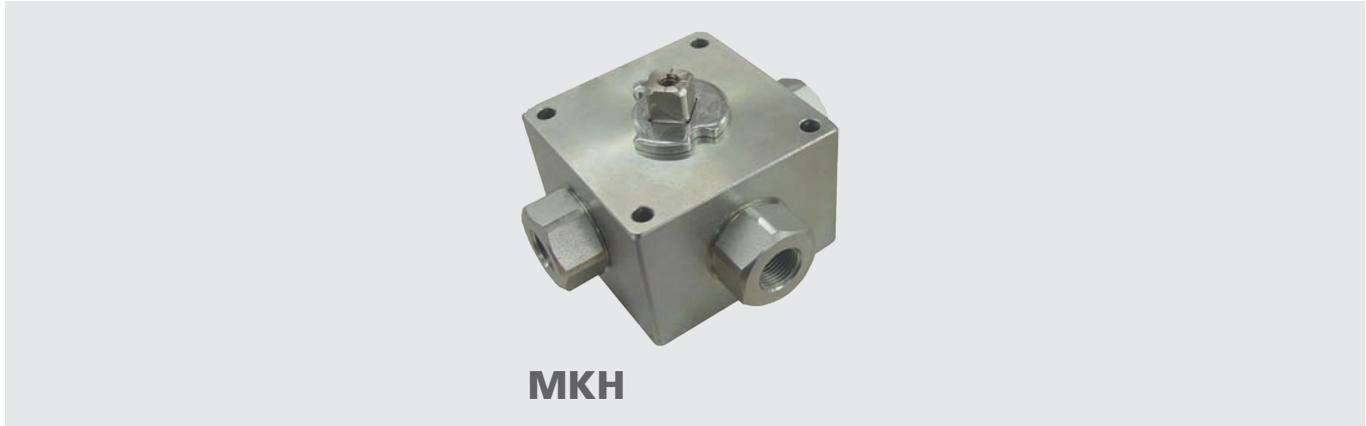
Die Mehrwegehähne besitzen eine Kükewelle und sind somit gelagert. Der Dichtkolben wird mittels eines vorgespannten O-Rings gegen die Kükewelle gepresst. Die Anpresskraft gegen die Kükewelle wird noch mit dem anstehenden Druck verstärkt, so dass die Mehrwegehähne im Vakuum, bei Niederdruck als auch Hochdruck absolute Dichtheit gewährleisten. Wartungsfreiheit wird durch die in Buchsen gelagerte Kükewelle gewährleistet.
