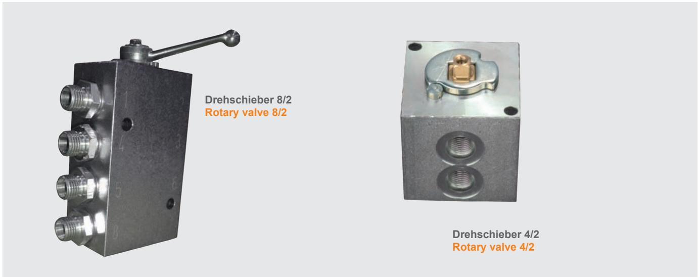
Diese Ventile sind gekennzeichnet durch einen zylindrischen Kolben der in einem Gehäuse gegengelagert ist und mit diesem eine metallische Dichtung bildet.
