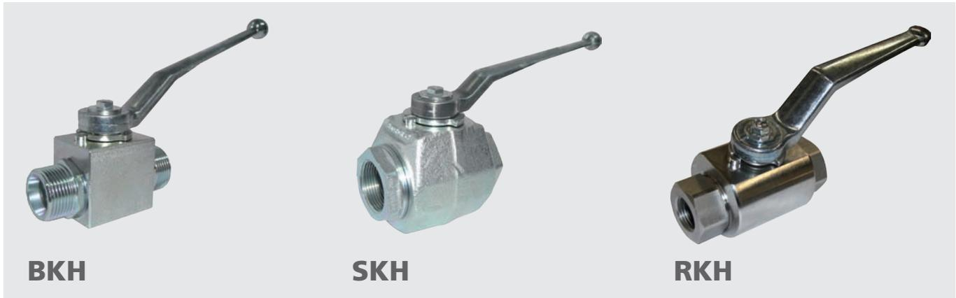
Bei den ungelagerten Kugelhähnen ist die Kugel schwimmend zwischen den Kugeldichtungen angeordnet. Sowohl im Vakuum, bei Niederdruck als auch Hochdruck wird aufgrund der eigenelastischen Vorspannung der Kugeldichtungen absolute Dichtheit gewährleistet. Die Schaltwelle ist ausblassicher ausgebildet. Die Kugelhähne sind wartungsfrei.
