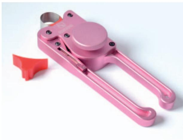
SEAL Clasper ist für den Einbau von PTFE Kolbendichtungen geeignet. Das Band ist aus rostfreiem Stahl und passt sich je nach Dimension der Dichtungen an, durch seinen HPU Dreieck-Schutz verhindert es Schäden während des Pressvorganges.
