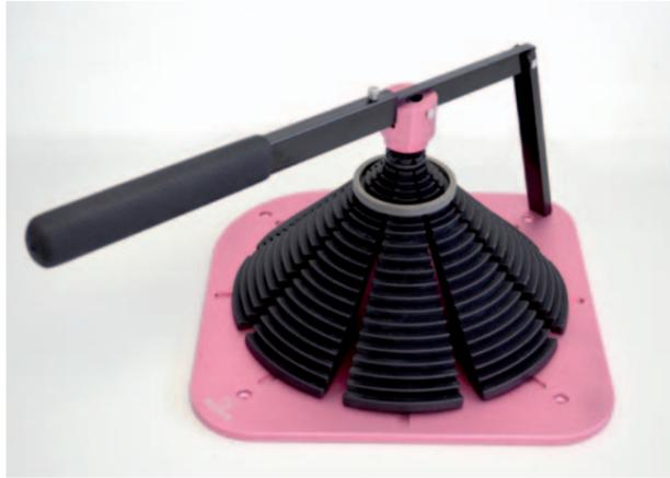
Der SEAL Stretcher+ ist ein Werkzeug zum Aufdehnen von PTFE Dichtungen. Durch Erwärmen in Öl oder Heißwasser bei ca. 80°C bis 120°C (Bitte Materialbeständigkeit zuerst prüfen) werden die PTFE-Werkstoffe geschmeidiger und lassen sich für die Montage wesentlich leichter aufdehnen und zurückverformen (kalibrieren).
